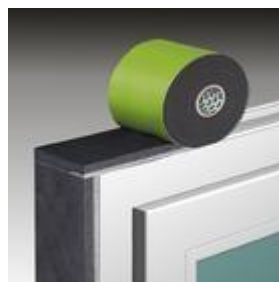
3 pav. TP652 klijavimas ant rėmo – pilką pakopą nukreipus į vidų. Kampuose reikia palikti užlaidą.
