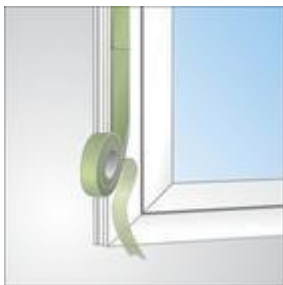
3 pav. Jungiamoji sandūra montuojant langą
