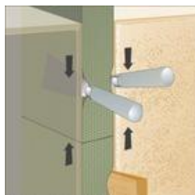
2 pav. Jungiamoji masyvios konstrukcijos sandūra
