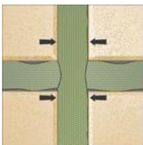
4 pav. Kryžminė sandūra
