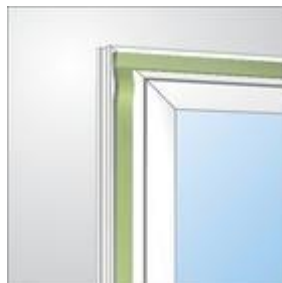
1 pav. Kampų apdirbimas montuojant langą
