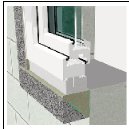
Pav.1 illbruck PR007 profilis su priklijuotu PR008 izoliaciniu profiliu
